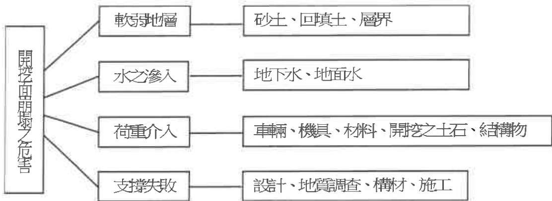
圖3.1 開挖面崩塌之危害狀況引導圖
