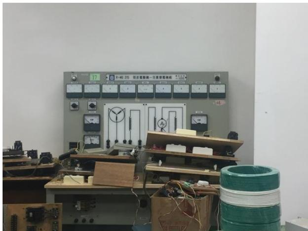
**編號 18 - 【複機電動機-複機發電機組】**
